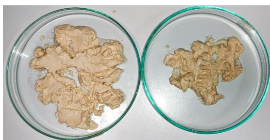
Εικόνα 13: Απομονωμένη πρωτεΐνη τυρογάλακτος μετά από καθίζηση στο ισοηλεκτρικό σημείο και φυγοκέντρηση.
