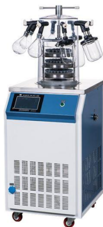
Εικόνα 19: Εικόνα εργαστηριακού λυοφιλοποιητή.
