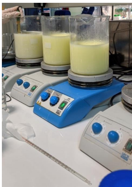
Εικόνα 12: Προετοιμασία τυρογάλακτος, θέρμανση και αλλαγή pH.
