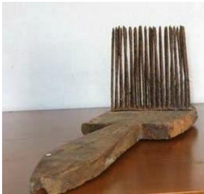
Εικόνα 10. Με το λανάρι γίνεται το λανάρισμα ή ξάσιμο του μαλλιού για να ανοίξουν οι ίνες και να γίνει η λεγόμενη «τουλούπα»
