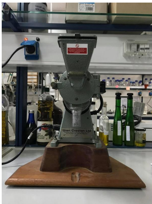
Εικόνα 8. Μύλος Willey που χρησιμοποιήθηκε για κονιορτοποίηση των φυτικών ιστών.
