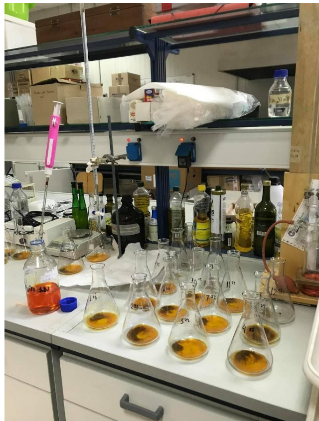
Εικόνα 7. Προετοιμασία δειγμάτων εδάφους για το προσδιορισμό της οργανικής ουσίας με τη μέθοδο υγρής οξείδωσης
