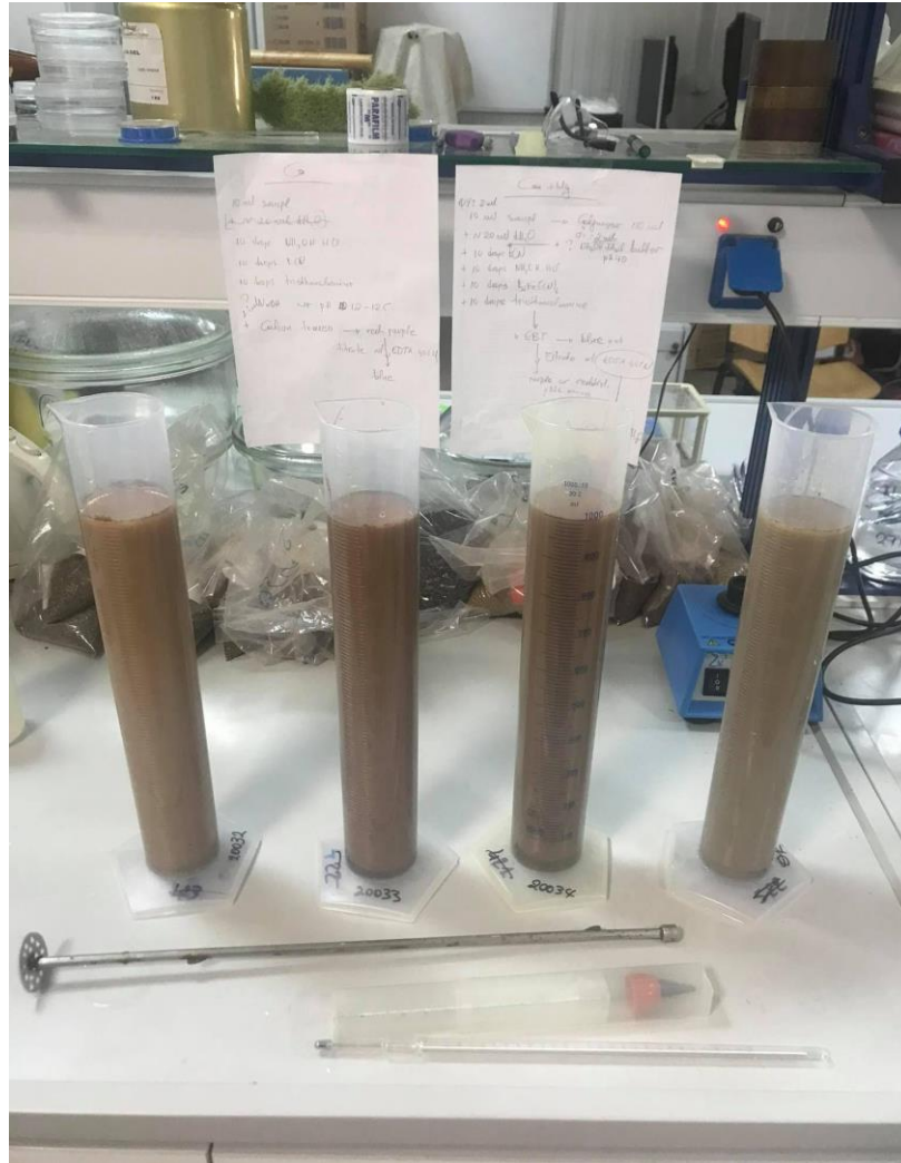
Εικόνα 6. Προσδιορισμός μηχανικής σύστασης εδάφους με τη μέθοδο BOUYOUCOS
