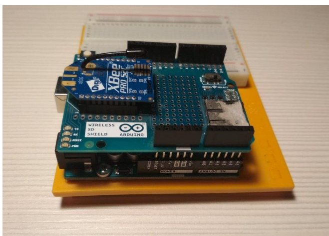
Σχήμα Γ΄.6: Συνδεδεμένο Arduino Uno με Wireless SD Shield και την κεραία Xbee Radio Module που χρησιμοποιήθηκε για τα πειράματα της παρούσας εργασίας.
