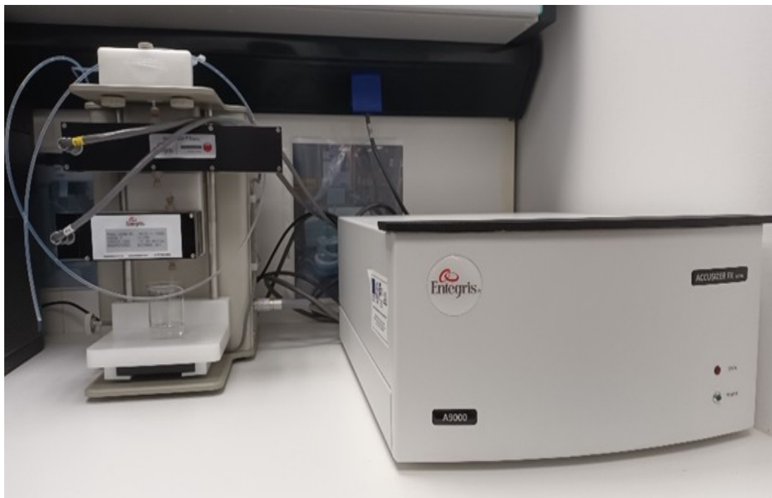
Εικόνα 5: Συσκευή Accusizer μοντέλο FxNano. Από τα αριστερά προς τα δεξιά: αναλυτής ύψους παλμών, οι δύο αισθητήρες (πάνω ο FxNano, κάτω ο LE-400-05) και το σύστημα αγωγών εισόδου και εξόδου των ρευστών
