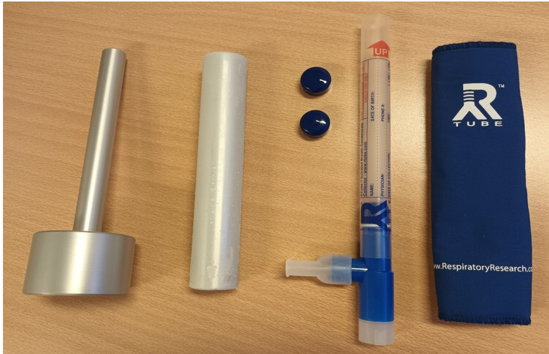
Εικόνα 3: RTube (Respiratory Research, Austin, TX, USA). Από τα δεξιά προς τα αριστερά: μονωτικό κάλυμμα, σωλήνας – θάλαμος RTube, 2 πώματα, χιτώνιο ψύξης και έμβολο.
