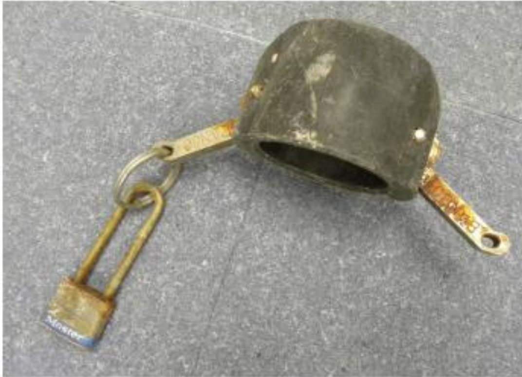
Εικόνα 7: Ένας διαχωριστικός δακτύλιος λείπει από το προστατευτικό κάλυμμα του υποχλωριώδους νατρίου. Ο διαχωριστικός δακτύλιος που λείπει εμπόδισε το κλείδωμα του καλύμματος με το λουκέτο (Πηγή:CSB)
