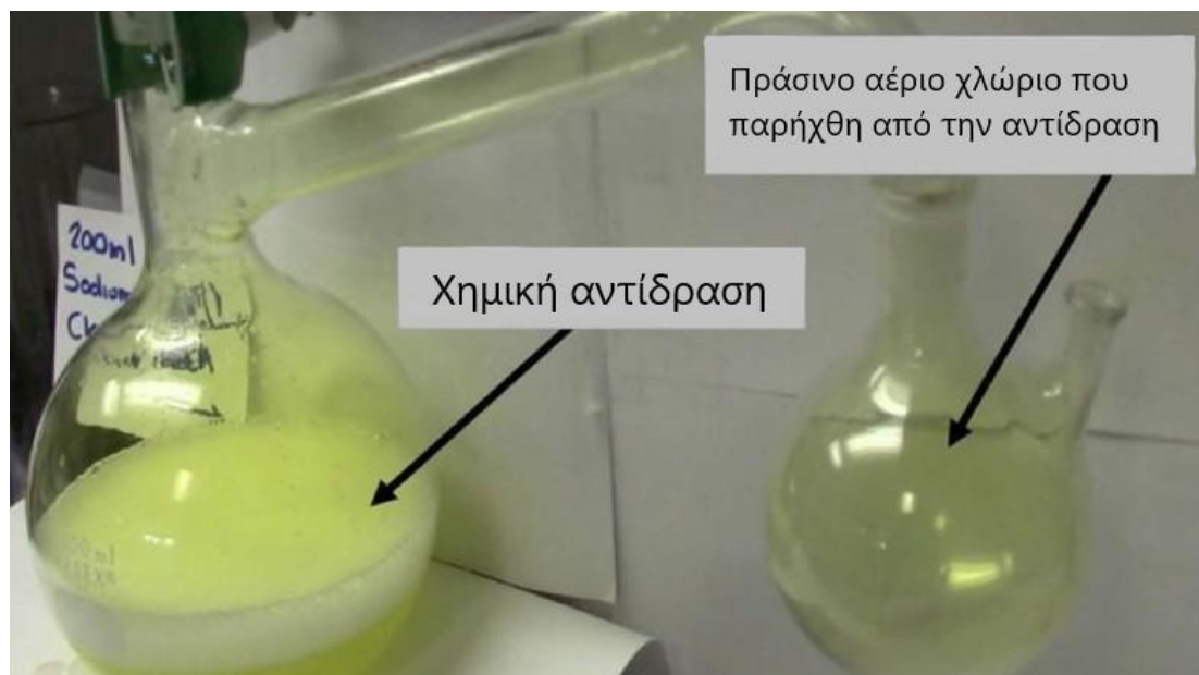
Εικόνα 9: Χημική αντίδραση περίπου 1 λεπτό αφού το δείγμα θειικού οξέος της Harsco προστέθηκε σε χλωρίνη Clorox (υποχλωριώδες νάτριο 5-10% 28 ). Το μείγμα των 2 είχε ως αποτέλεσμα το σχηματισμό μικρών φυσαλίδων αερίου χλωρίου (αριστερά) που συλλέχθηκαν σε συσκευή απόσταξης (δεξιά) (Πηγή: CSB)
