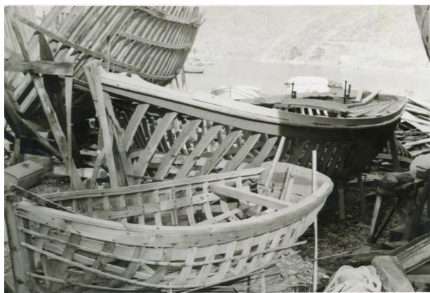
Εικ. 5: Σκελετός ξύλινου σκάφους με Φούρμες. Σύμη 1964 (Φωτ. Παπαδόπουλος Σ.)
