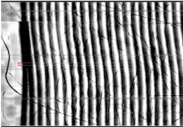
Εικόνα 8: Καταγραφή ήχου με τη μορφή αυλακώσεων, πάνω σε κέρινο κύλινδρο φωνογράφου, 1913 (scan σε μεγέθυνση).
