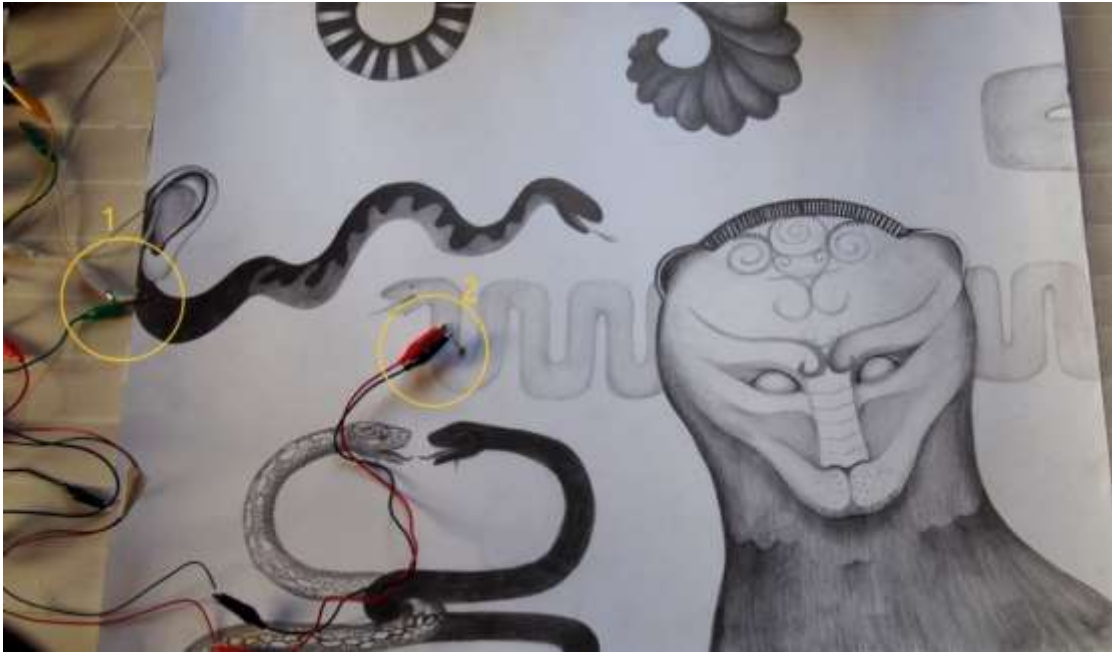
Εικόνα 2. Δοκιμές πριν από την υλοποίηση του εργαστηρίου: αισθητήρας φωτός/photocell και ηλεκτρόδια συνδεδεμένα σε σχέδιό μου με αφορμή το αέτωμα της Γοργούς. Στο σημείο 1 βλέπουμε το ένα ηλεκτρόδιο συνδεδεμένο με το σχέδιο από αγώγιμο, μαλακό γραφίτη, στο σημείο 2 το photocell για την ηχητική «ανάγνωση» των τονικών διαβαθμίσεων.
