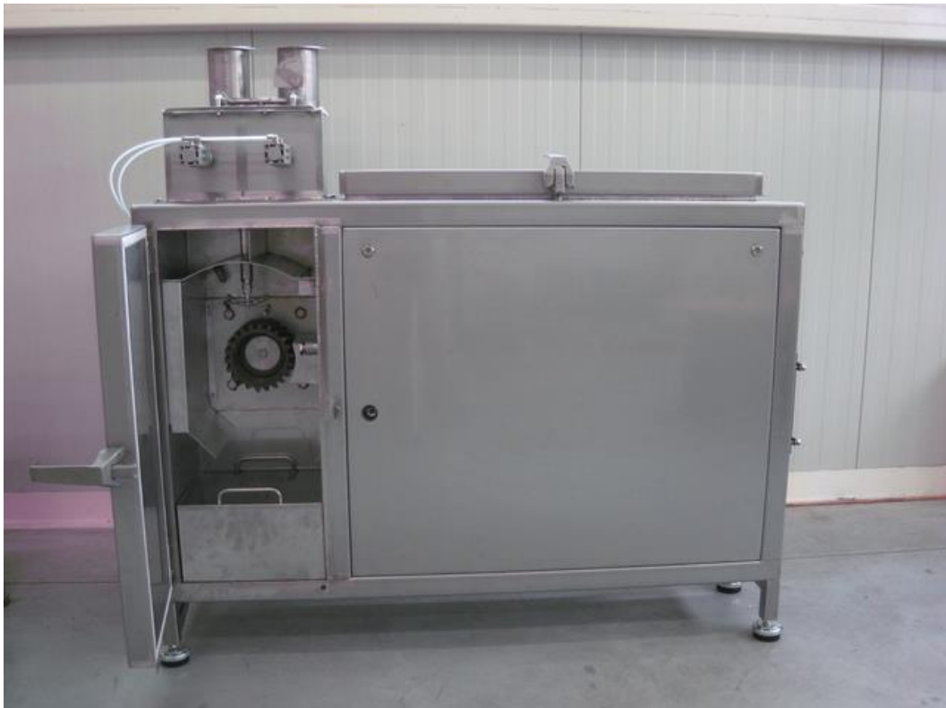
Εικόνα 4.6. Γεννήτρια καπνού τριβής (Διαθέσιμο στο:
