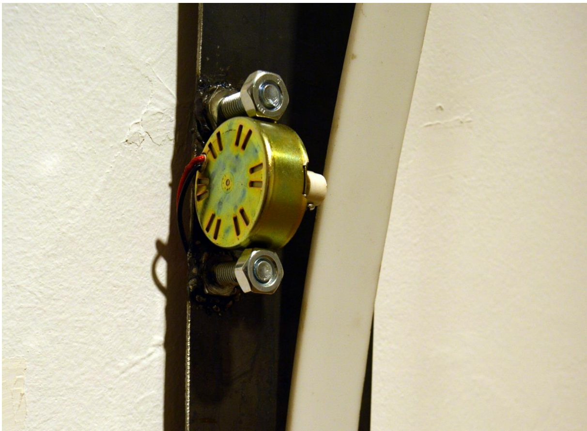
Λεπτομέρεια μοτέρ κατασκευής.
