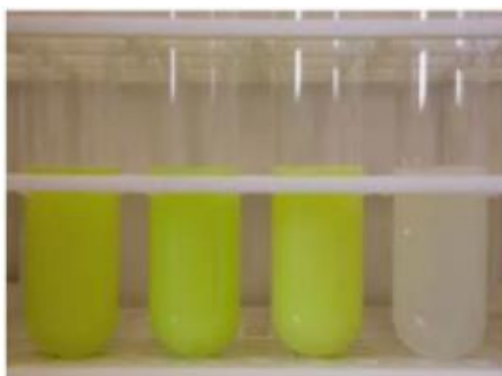
Εικόνα 3: Ανίχνευση αλκαλικής φωσφατάσης με την εμφάνιση κίτρινου χρώματος (Πηγή: Microbiology Note).
