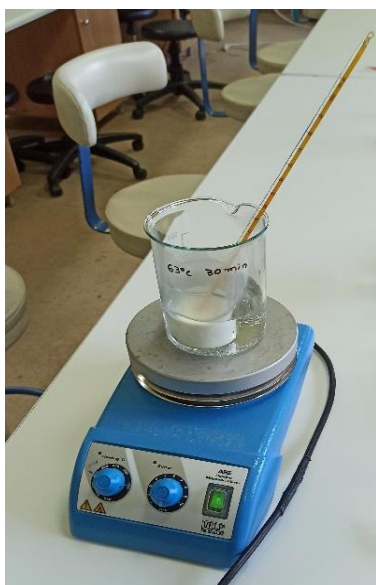
Εικόνα 12: Παστερίωση γάλακτος μέσω του θερμαινόμενου μαγνητικού αναδευτήρα (Πηγή: Προσωπικό αρχείο)
