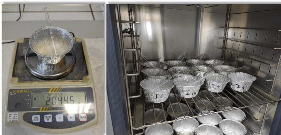
Εικόνα 4.4: Αριστερά, υπολογισμός βάρους κάψας-άμμου-ράβδου και δεξιά κάψες στο φούρνο ξήρανσης.
