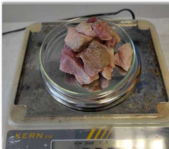
Εικόνα 4.5: Ζύγισμα πριν το μαγείρεμα για τη μέτρηση % απώλειας νερού.
