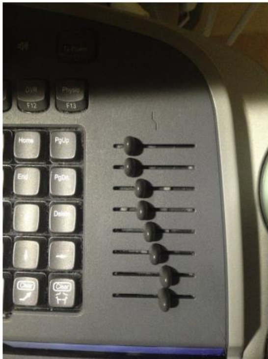
Εικόνα 5 TGC σε υπερηχογράφημα. Τα ρυθμιστικά κουμπιά μοιάζουν με ισοσταθμιστή σε στερεοφωνικό. Το Το κέρδος μπορεί να μεταβάλλεται με το βάθος. Σημειώστε εδώ ότι το κέρδος αυξάνεται προς τα κάτω.
