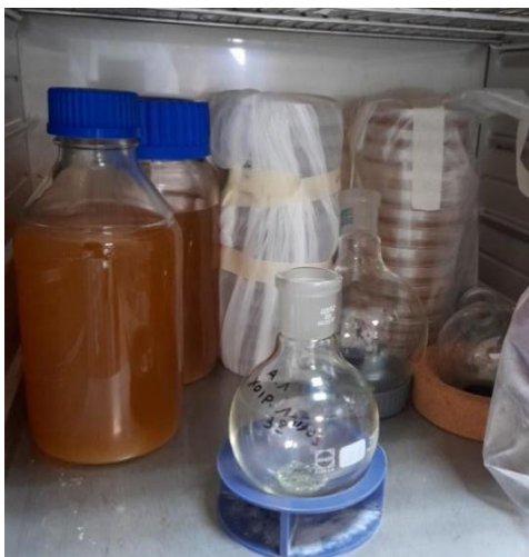
Εικόνα Α.5. Απομάκρυνση εξανίου σε θερμοθάλαμο 37°C.
