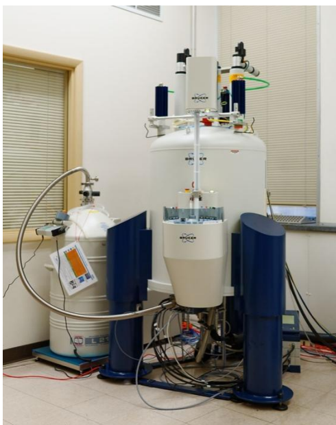
Εικόνα 4.2. Μηχάνημα πυρηνικού μαγνητικού συντονισμού NMR (Department of Chemistry, Mellon College of Science).
