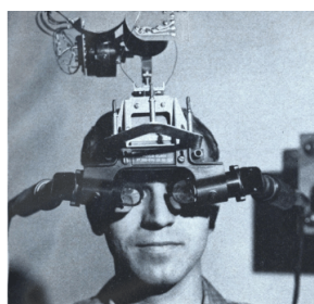
Σχήμα 2.1: Το HMD του Ivan Sutherland, αλλιώς γνωστό ως "Δαμόκλεια Σπάθη (Sword of Damocles)" [2]
