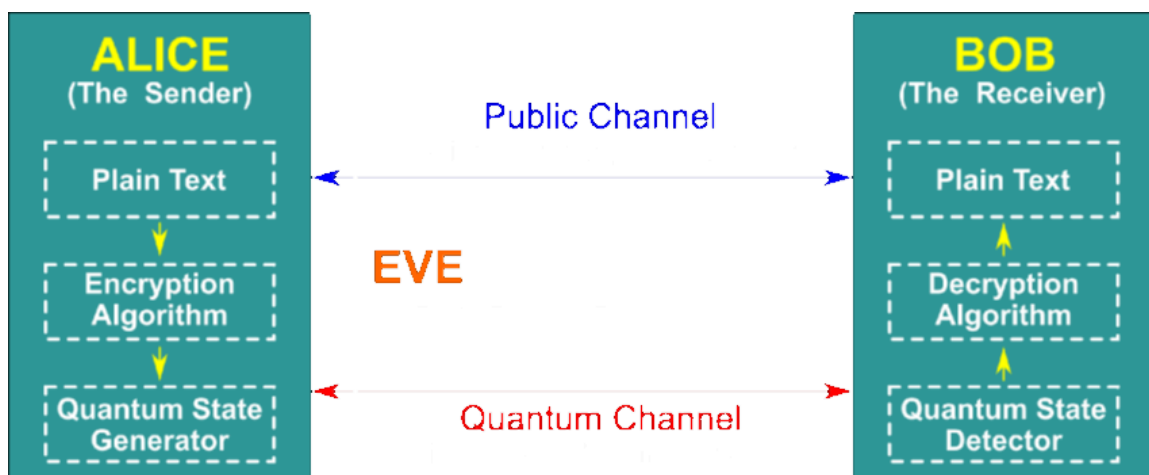
Εικόνα 4. Block Diagram ενός QKD συστήματος ( https://ieeexplore.ieee.org/document/8527822 ).
