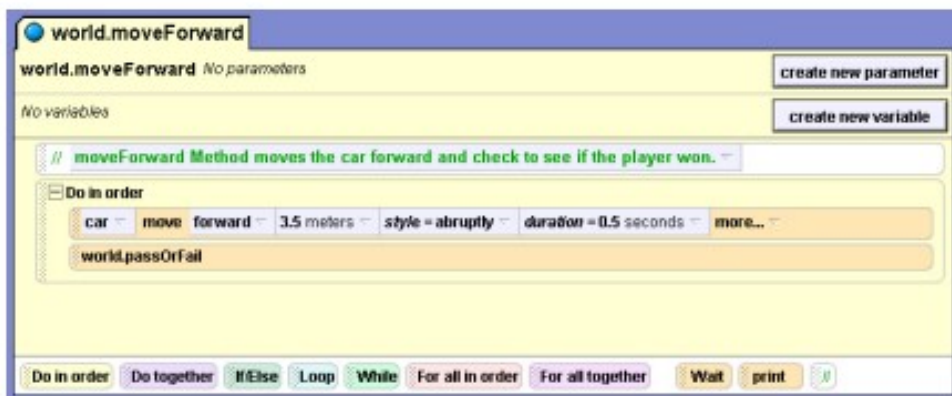
Εικόνα 7: moveForward μέθοδος καθορισμένη από το χρήστη για να μετακινήσετε το αυτοκίνητο μπροστά στο παιχνίδι δοκιμής οδήγησης. Αυτή η μέθοδος ενεργοποιείται όταν ενεργοποιείται το πρόγραμμα χειρισμού συμβάντων πλήκτρου επάνω βέλους (↑).
