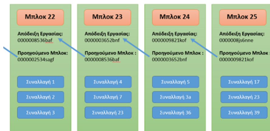
Σχήμα Α.1: απεικόνιση τμήματος ενός blockchain. (Πηγή: HBH (Hellenic Blockchain Hub): https://www.blockchain.org.gr/home/mathe/ )
