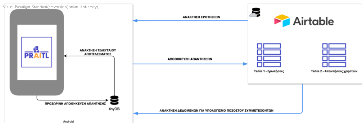
Εικόνα 3. Γενικό μοντέλο Πληροφοριακού συστήματος
