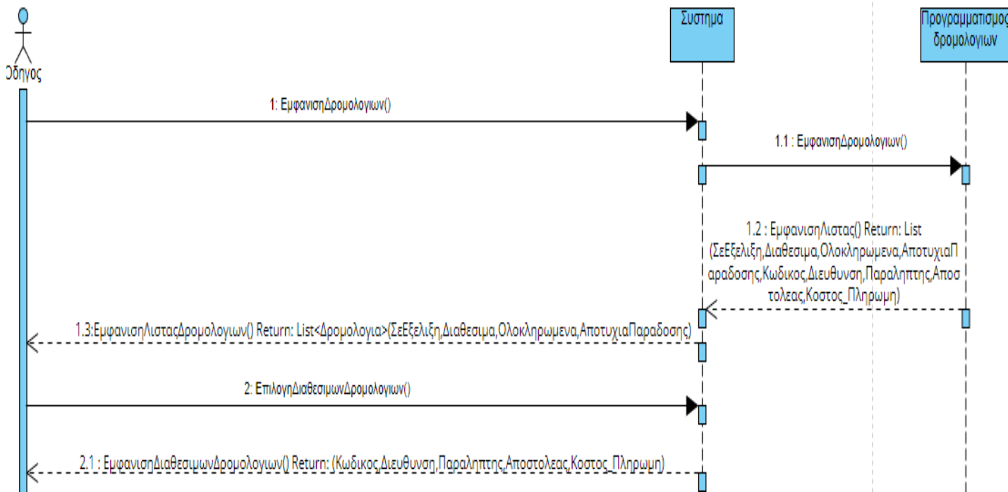
Εικόνα 42: Προβολή δρομολογίων στον οδηγό της εταιρίας – Sequence Diagram
