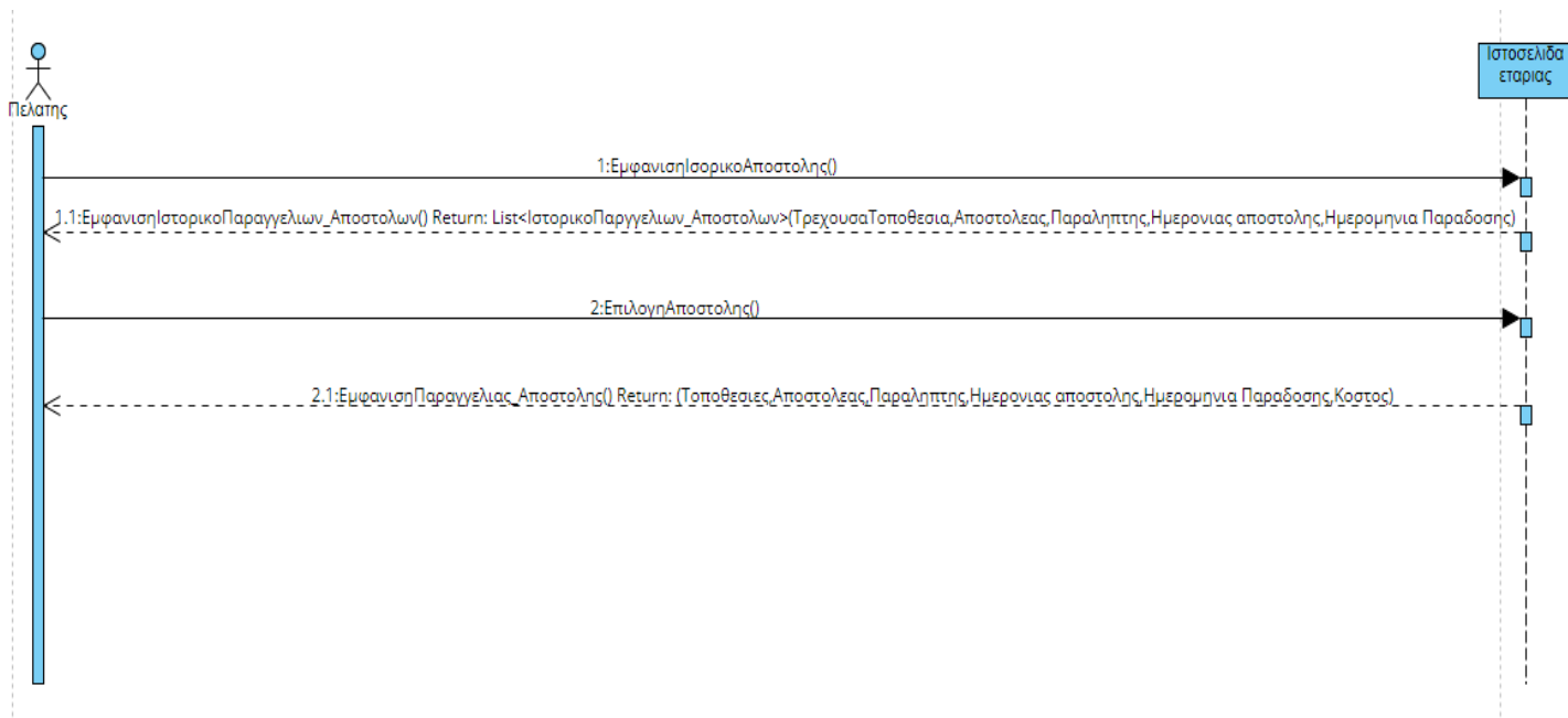
Εικόνα 28: Εμφάνιση Ιστορικού αποστολών – Sequence Diagram
