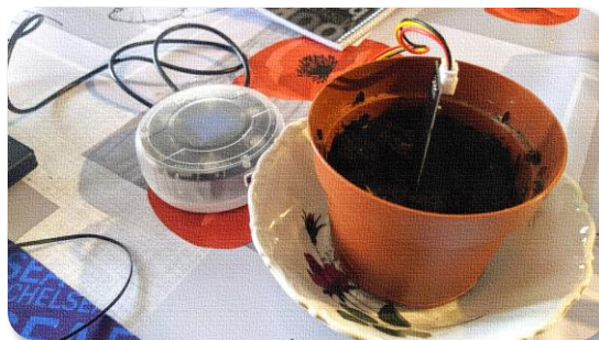
Σχήμα. 25. Ο μικροελεγκτής (Arduino) και ο αισθητήρας καταγραφής εδαφικής υγρασίας
