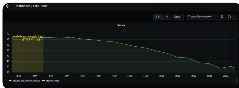
Σχήμα. 33. Πρόβλεψη τιμών υγρασίας εδάφους με την αξιοποίηση του μοντέλου πρόβλεψης Holt-Winters
