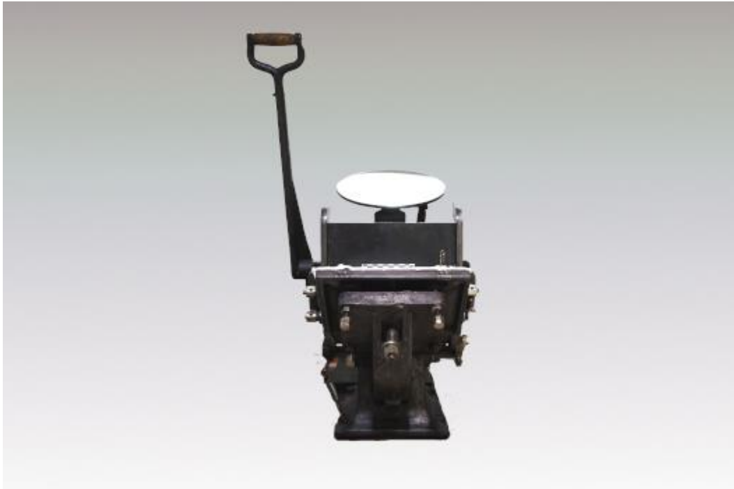
Εικ. 30. Όρθιο χειροκίνητο τυπογραφικό πιεστήριο ΚΡΟΝΟΣ.
