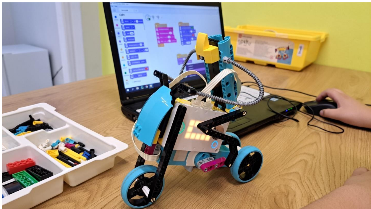
Εικόνα 29: Η κατασκευή του Bicycle με LEGO Spike Prime
