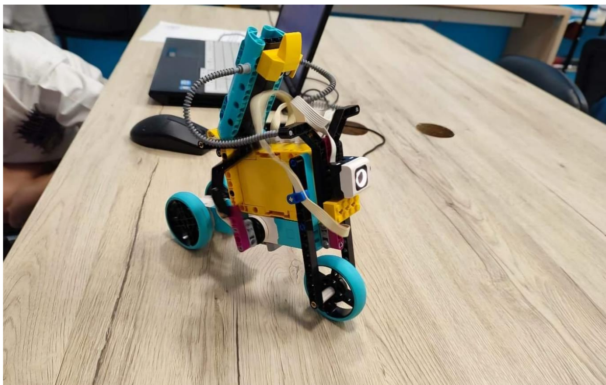
Εικόνα 31: Το ποδήλατο με την προσθήκη ενός αισθητήρα χρώματος
