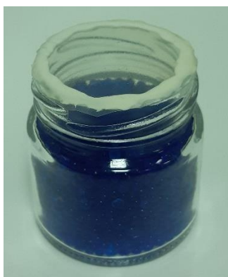
Εικόνα 3.4.1 Δείγμα μεμβράνης προς μέτρηση της ικανότητας διαπερατότητας υδρατμών (WVP)
