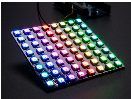
Εικόνα 15: NeoPixel NeoMatrix 8x8 - 64 RGB LED Pixel Matrix της Adafruit (Industries, Adafruit χ.χ.)
