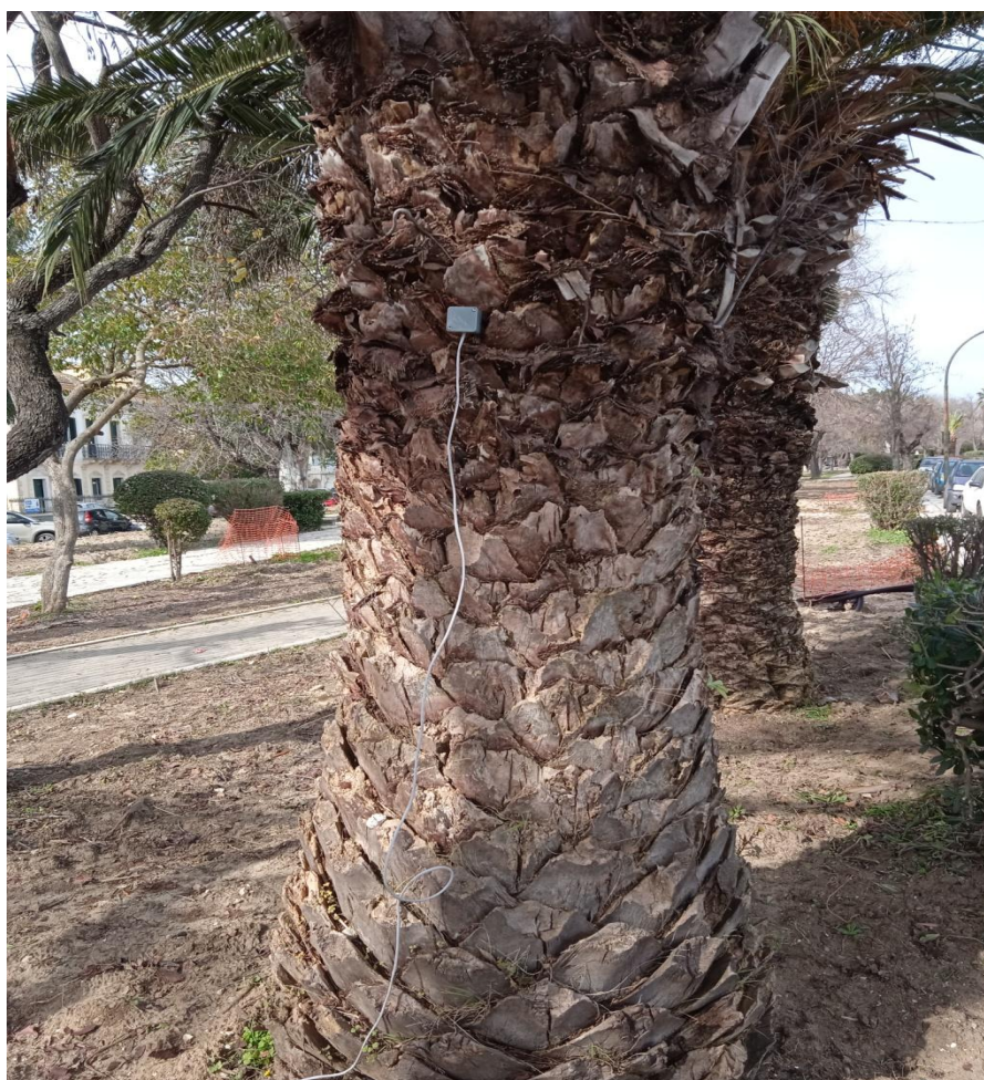
Εικόνα 39: Ο αισθητήρας της συσκευής τοποθετημένος στον φοίνικα
