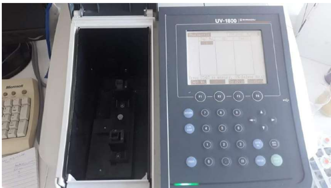
Εικόνα 53. Φασματοφωτόμετρο με τοποθετημένο τυφλό δείγμα έτοιμο για φωτομετρήσεις στα 415nm
