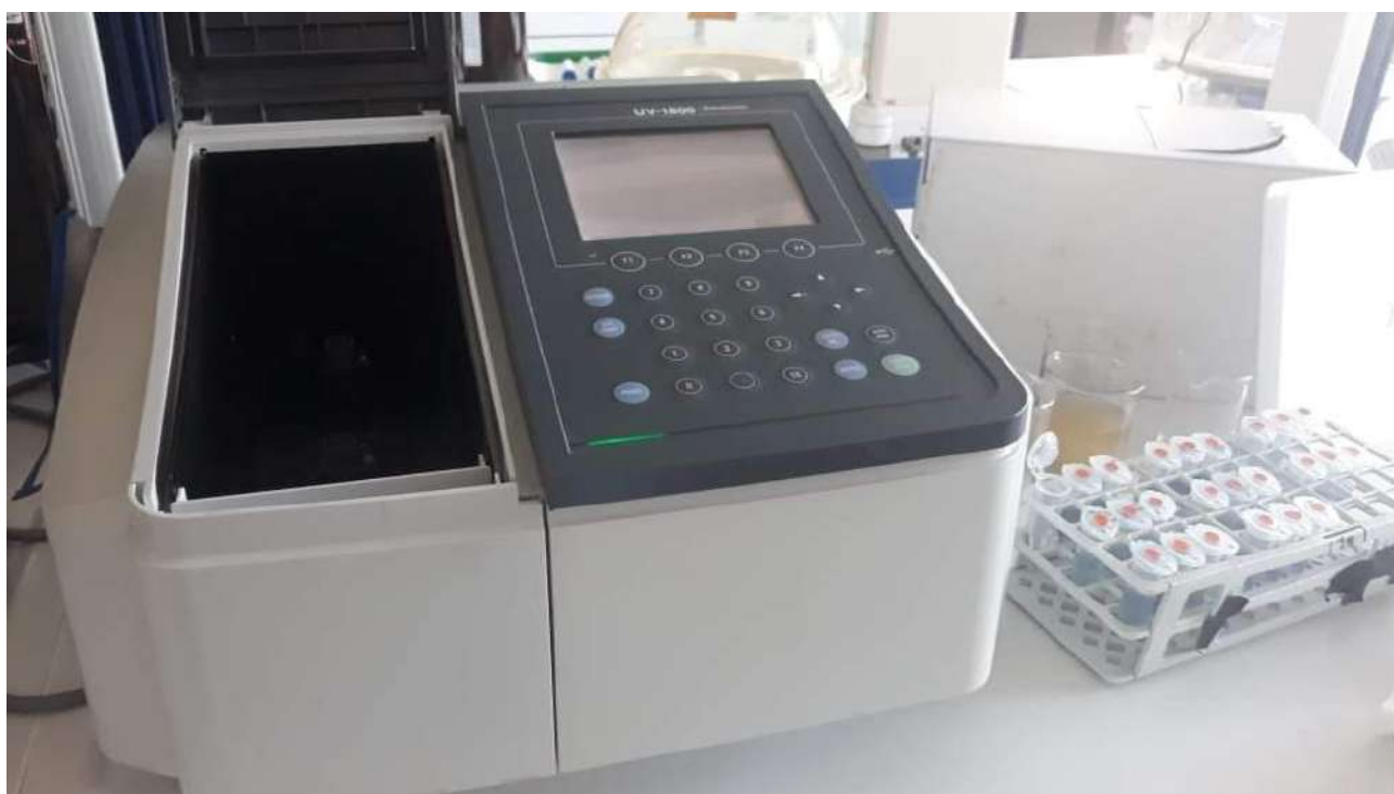
Εικόνα 52. Φασματοφωτόμετρο έτοιμο για φωτομετρήσεις
