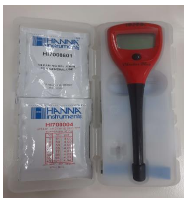
Εικόνα 2. Εργαστηριακό φορητό pH-μετρο (Πηγή: Προσωπικό αρχείο).
