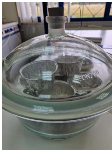
Εικόνα 7. Κάψες χωρίς δείγμα, τοποθετημένες στον ξηραντήρα με σκοπό να έρθουν σε θερμοκρασία δωματίου (Πηγή: Προσωπικό αρχείο).
