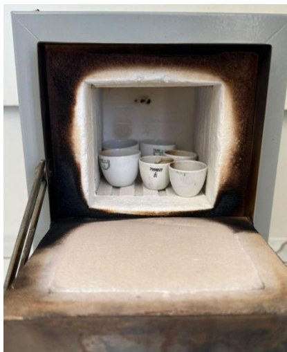
Εικόνα 9. Κάψες πορσελάνης με δείγμα κρέατος μετά την απανθράκωση (Πηγή: Προσωπικό αρχείο).
