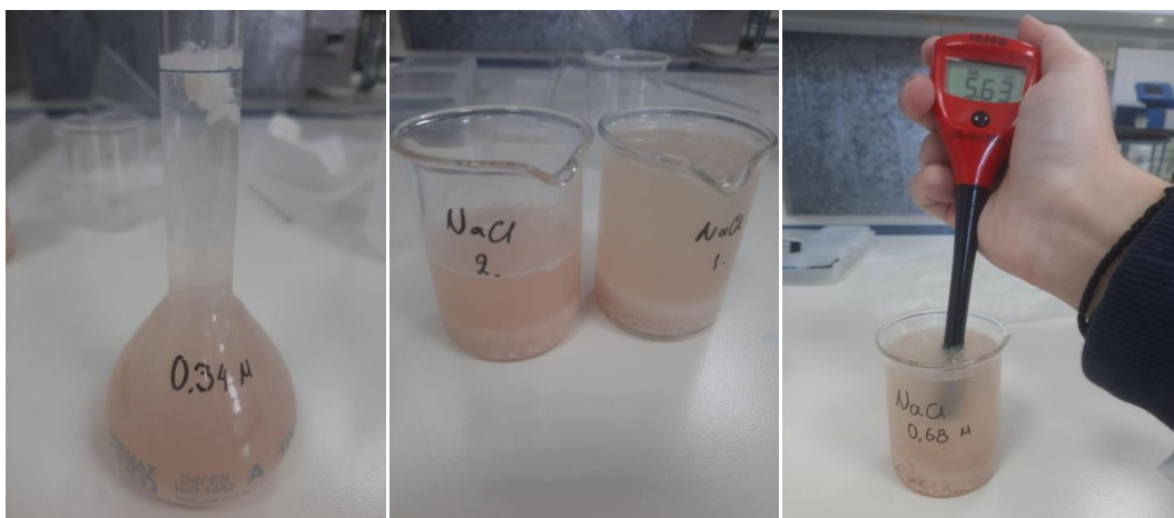
Εικόνα 3. (1) Ομογενοποιημένο δείγμα συγκέντρωσης 0,34M σε ογκομετρική φιάλη των 100mL. (2) Τα δείγματα την στιγμή που έχουν αφεθεί σε ηρεμία. (3) Υπολογισμός της ενεργού οξύτητας με μετρητή pH (Πηγή: Προσωπικό αρχείο).
