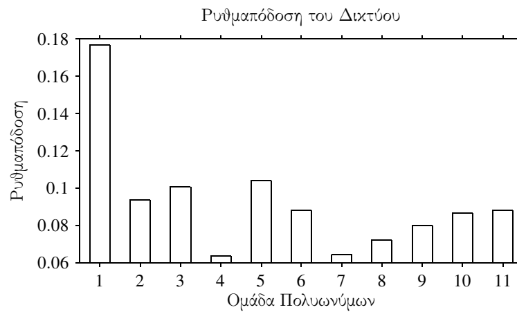
Σχήμα Ε'.1: Το throughput συναρτήσει των διαφόρων ομάδων από πολυώνυμα. Σε όλες τις περιπτώσεις βρίσκεται μεταξύ της μέγιστης 0.2 και ελάχιστης 0.04 τιμής.
