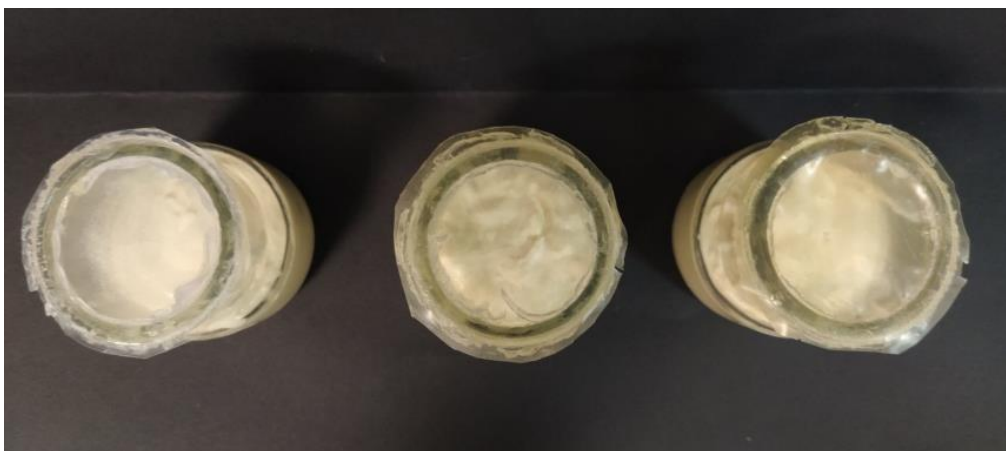
Εικόνα 7. Βιώσιμη συσκευασία αλοιφώδους τυριού σε γυάλινο περιέκτη σφραγισμένο με πλαστική μεμβράνη (PL) και βιοαποικοδομήσιμες μεμβράνες από πρωτεΐνη τυρογάλακτος εμπλουτισμένη με αιθέριο έλαιο ρίγανης (WPC+EO) και επιπρόσθετα με βακτηριακή κυτταρίνη (WPC+BC+EO).
