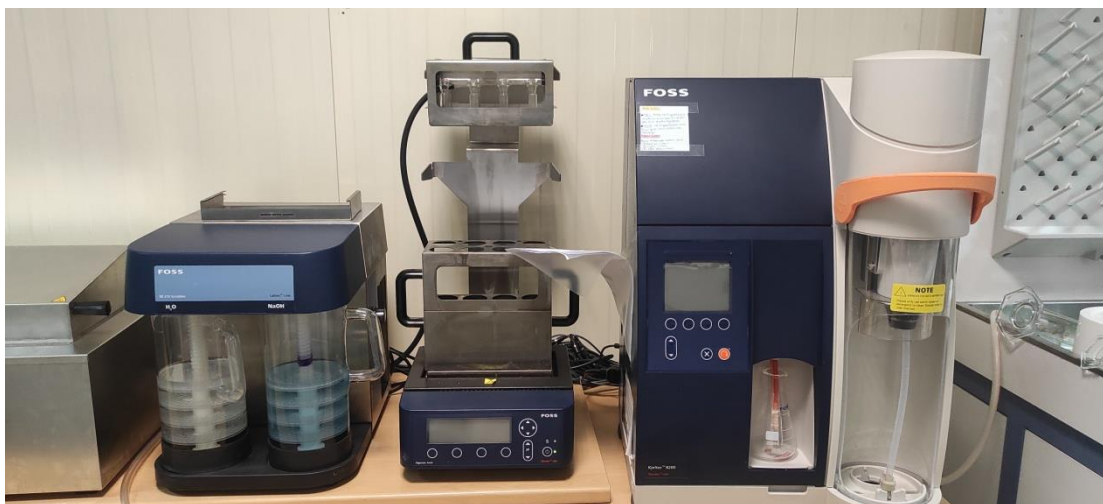
Εικόνα 3. Συσκευή προσδιορισμού πρωτεΐνης κατά Kjeldahl που χρησιμοποιήθηκε κατά τη διάρκεια των πειραμάτων
