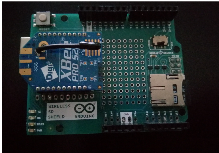
Σχήμα Β'.3: Το Arduino Uno πάνω στο οποίο έχει τοποθετηθεί η κεραία XBee S2C Pro ZigBee και η SD.
