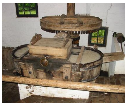
Εικόνα 7 «Ολλανδός» πολτοποιητική μηχανή. Πηγή: https://el.wikipedia.org/wiki/Ολλανδός_(μηχανή)#/media/File:Hollander.jpg (τελευταία ημερομηνία προσπέλασης 25/11/2018)
