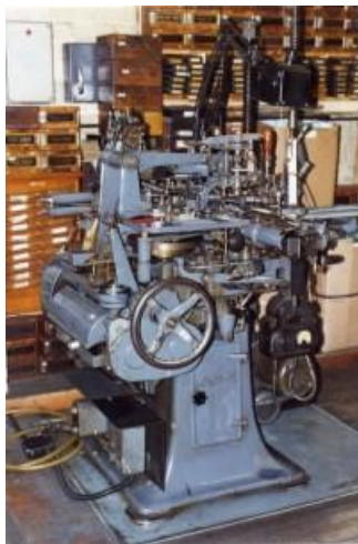
Εικόνα 12 : Μονοτυπία. Πηγή: British Letterpress http://britishletterpress.co.uk (τελευταία ημερομηνία προσπέλασης 2/11/2018)
