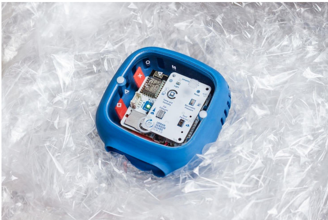
Εικόνα 5: Ένα Smart Citizen Kit με την πλακέτα Urban στο περιβλήμα του. Πηγή: https://wikifactory.com/@elgranpri/smart-citizen-kit
