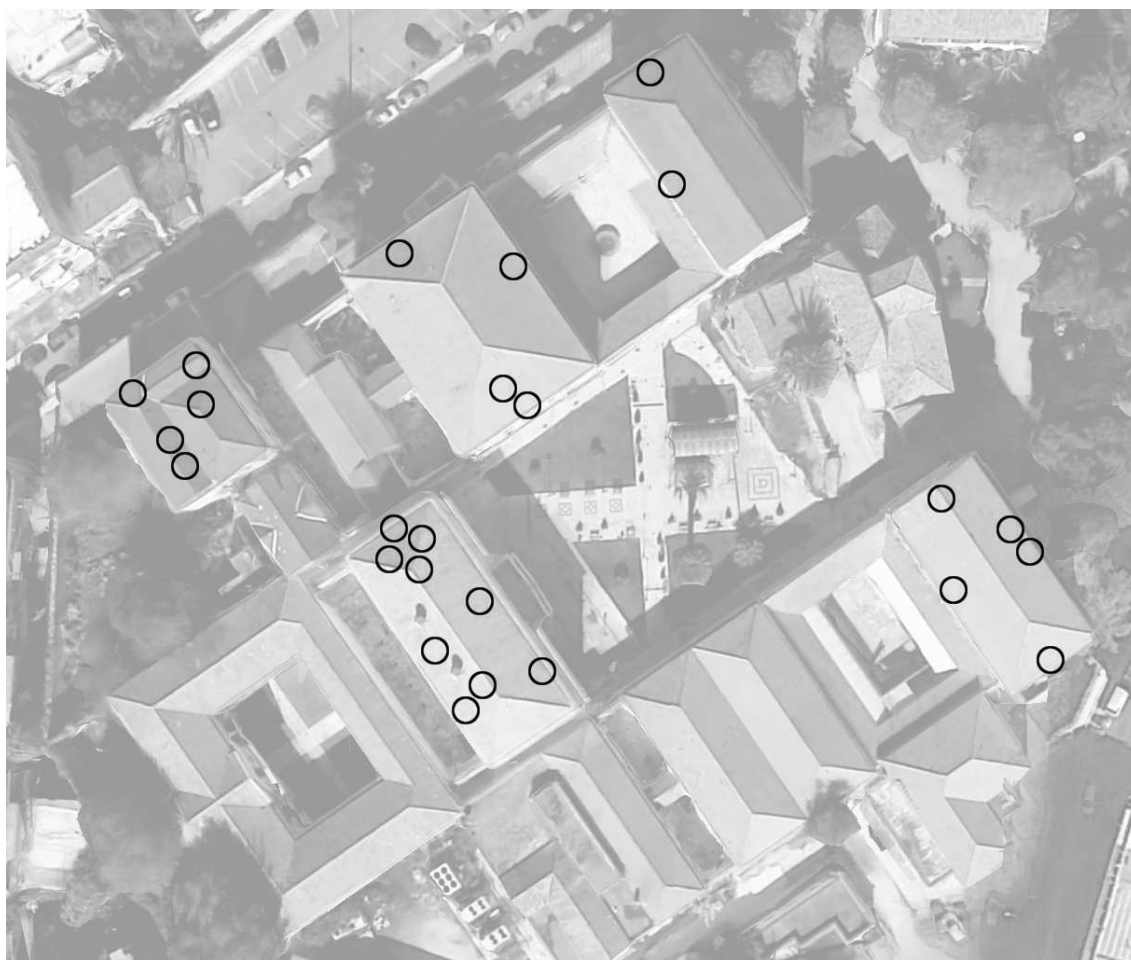
Σχήμα Δ΄.1: Τοποθέτηση των κόμβων του δικτύου, που σημειώνονται με κύκλους, στις πανεπιστημιακές εγκαταστάσεις.
