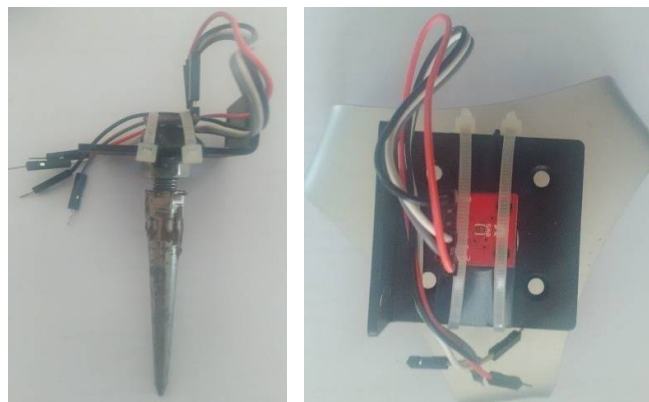
Εικόνα 65: Ιδιοκατασκευή Στήριξης Ψηφιακού Επιταχυνσιόμετρου MMA8452Q
