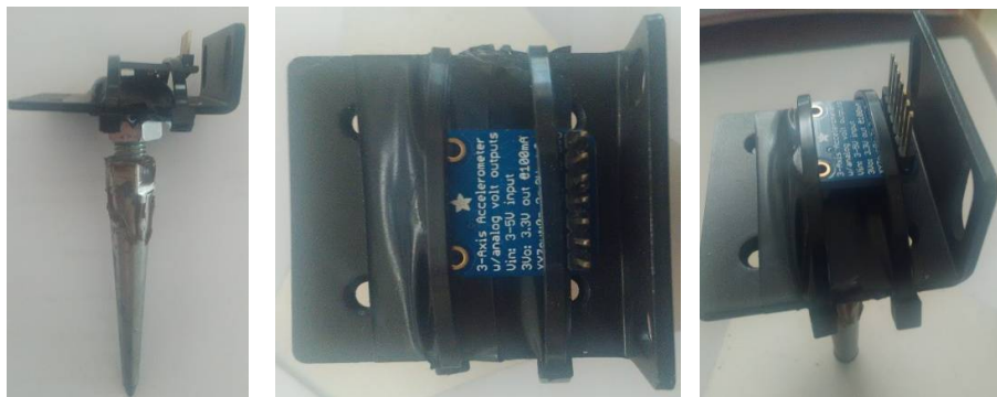
Εικόνα 64: Ιδιοκατασκευή Στήριξης Αναλογικού Επιταχυνσιόμετρου ADXL335
