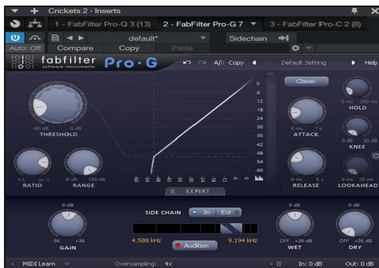
Εικόνα 19. Απεικόνιση του plugin Fabfilter Pro-G με συγκεκριμένες ρυθμίσεις για το gate του ήχου των τζιτζικιών.
