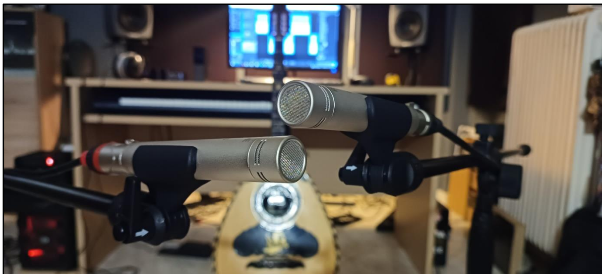
Εικόνα 12. Η τεχνική ηχογράφησης XY με δύο πυκνωτικά μικρόφωνα.
