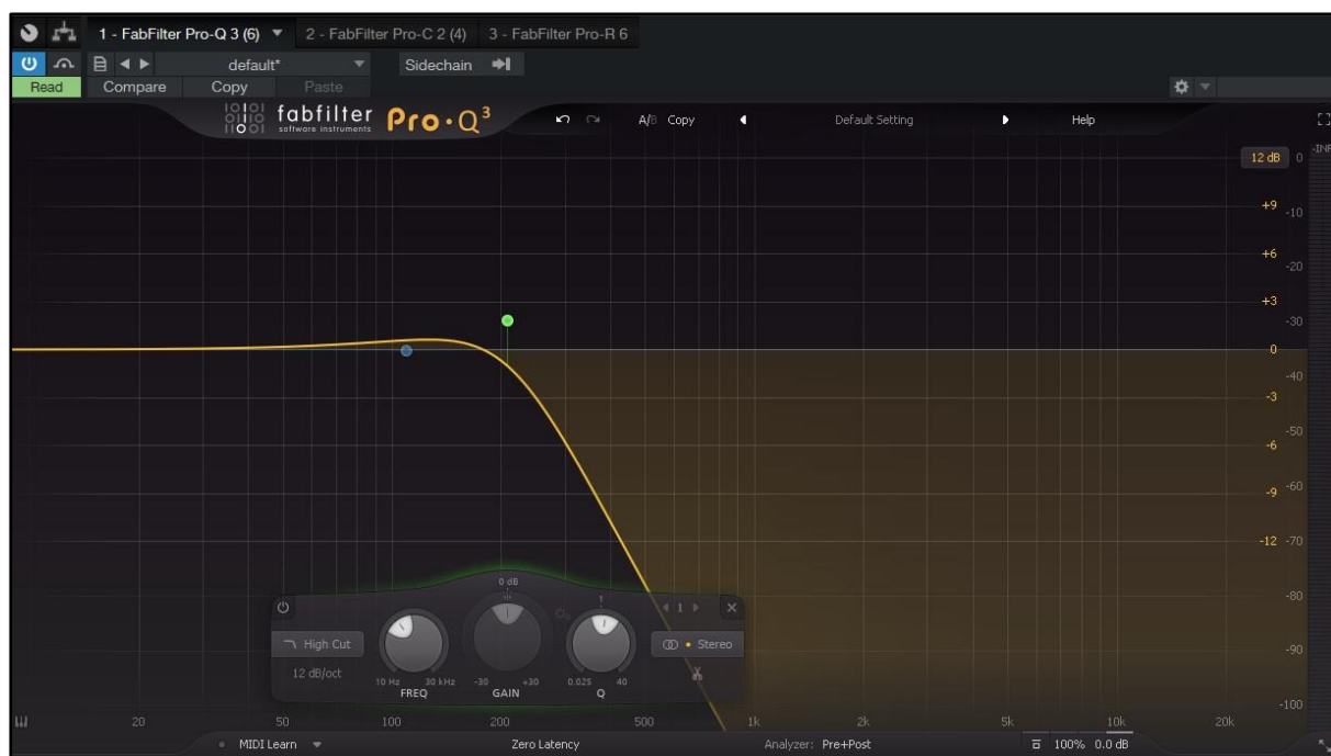
Εικόνα 20. Απεικόνιση του plugin Fabfilter Pro-Q με συγκεκριμένες ρυθμίσεις για το EQ του υπόβαθρου του βυθού.
