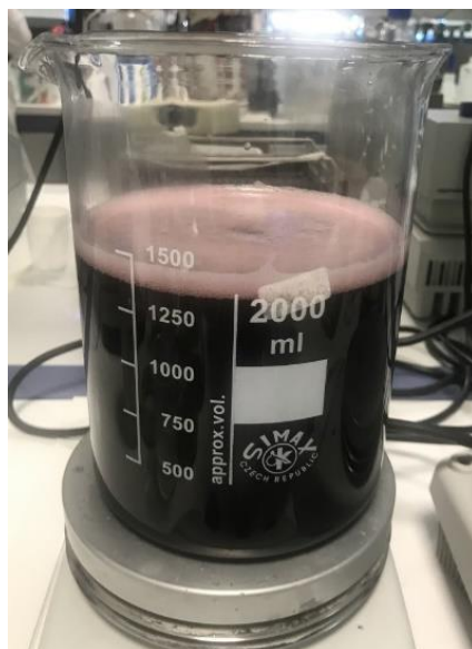
Εικόνα 10: : Παρασκευή θρεπτικού υποστρώματος από στέμφυλα οиноποιίας.
