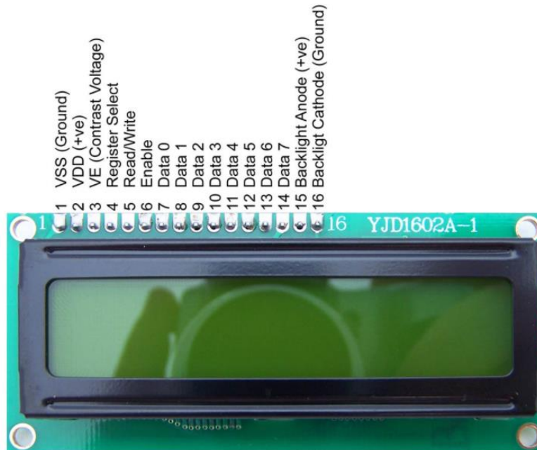
Κύκλωμα 14. Ακροδέκτες του LCD Monitor
