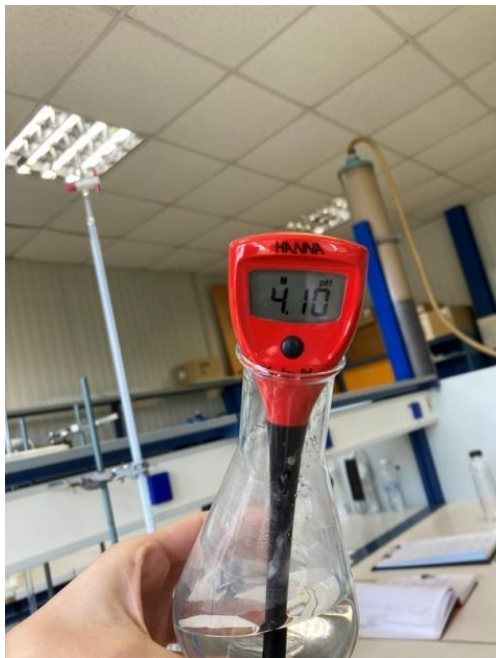
Εικόνα 12 : Μέτρηση pH με Πεχάμετρο
