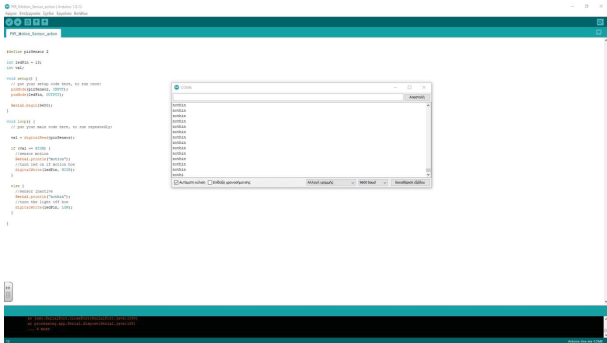
Εικ. 9. Το led δεν ανάβει αν δεν ανιχνεύσει κίνηση ο αισθητήρας. Εμφάνιση αποτελέσματος μέσω σειριακής.
