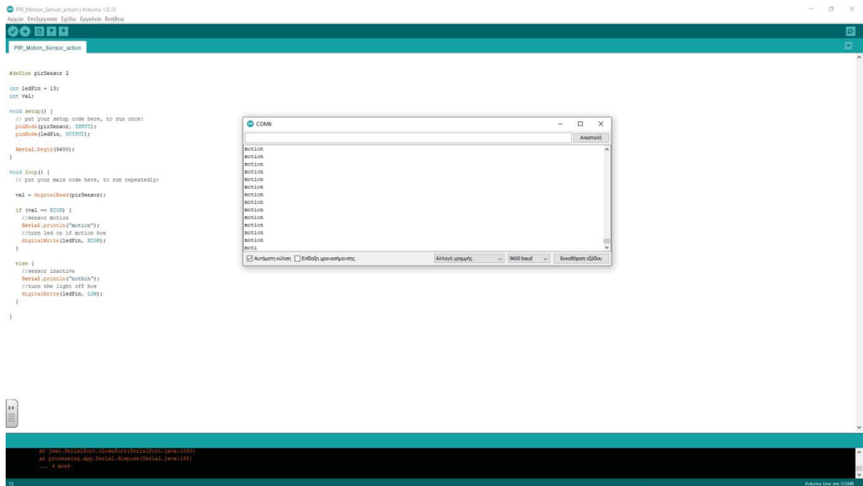
Εικ. 7. Το led ανάβει μόλις ανιχνεύσει κίνηση. Εμφάνιση αποτελέσματος μέσω σειριακής.
