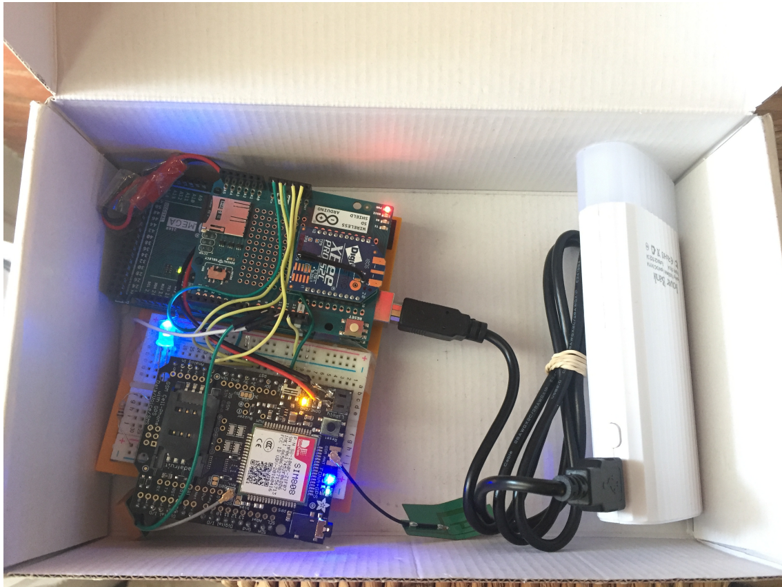
Σχήμα Ι.1: Το κάθε σύστημα MTS τοποθετήθηκε σε ένα όχημα για να συλλέγει μετρήσεις. Εδώ παρουσιάζεται μία συσκευή MTS η οποία τροφοδοτείται με ρεύμα από ένα Power Bank.
