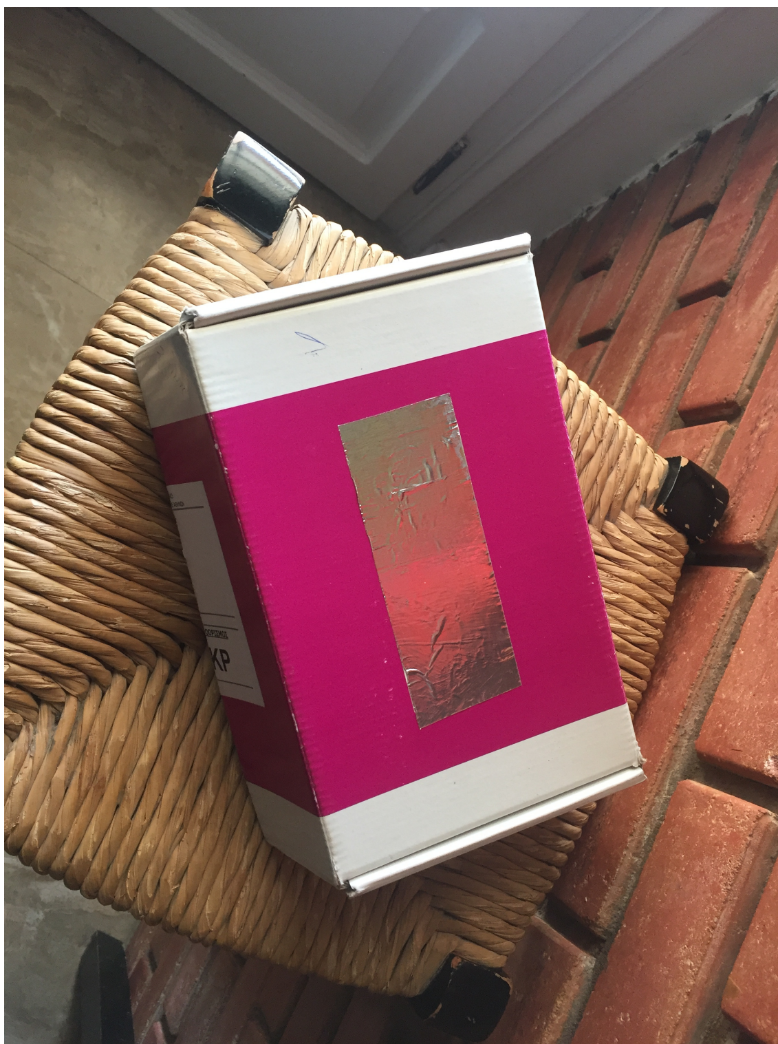
Σχήμα Ι.2: Η κάθε συσκευή MTS τοποθετήθηκε σε ένα μικρό κουτί. Έτσι το σύστημα μπορεί να τοποθετηθεί στο όχημα διακριτικά και προστατευμένο μέσα στο κουτί αυτό. Έτσι το σύστημα δεν είναι ευάλωτο κατά την διάρκεια της κίνησης του οχήματος αλλά δεν προκαλεί και στόχο για τον οδηγό και τους επιβάτες.
