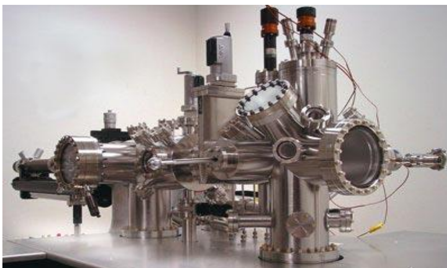
Εικόνα 5.2: Το ηλεκτρονικό μικροσκόπιο STM, το οποίο ανακαλύφθηκε το 1981.
