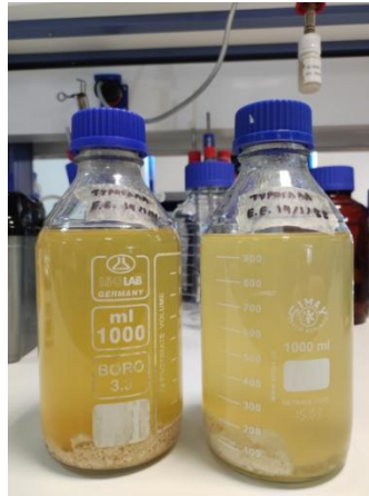
Εικόνα 2: Τυρόγαλα μετά την καθίζηση και πριν την απομάκρυνση των πρωτεϊνών
