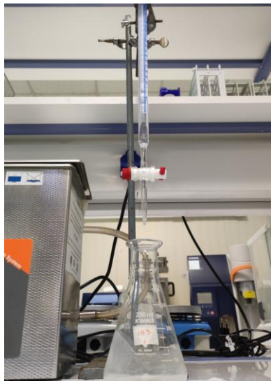
Εικόνα 12: Μέτρηση της ογκομετρούμενης οξύτητας
