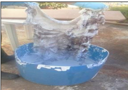
Εικόνα 12-13: Αφαίρεση του δέρματος από τον ασβέστη και τοποθέτηση αυτού σε λεία επιφάνεια, για αφαίρεση τριχών.
