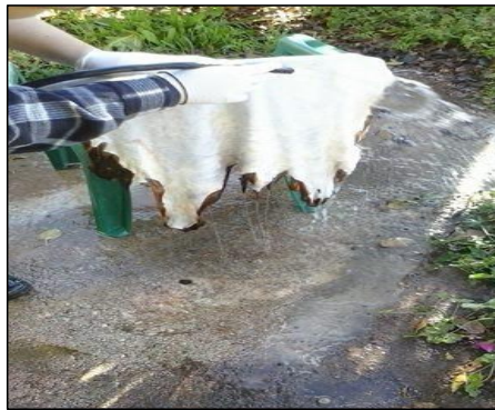
Εικόνα 68-9: Πλύσιμο του δέρματος από την πλευρά των τριχών και την πλευρά της σάρκας.
