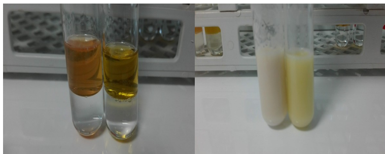
Εικόνα 3.6: Δοκιμή γαλακτωματοποίησης σε δύο διαφορετικά λάδια (20W-50 και ελαιόλαδο) με ανάδευση για 1 min σε vortex στη μέγιστη ταχύτητα.
