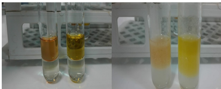
Εικόνα 3.7: Δοκιμή γαλακτωματοποίησης σε υπόστρωμα M2 σε δύο διαφορετικούς τύπους λαδιού (20W-50 και ελαιόλαδο) με ανάδευση 1 min σε vortex στη μέγιστη ταχύτητα.
