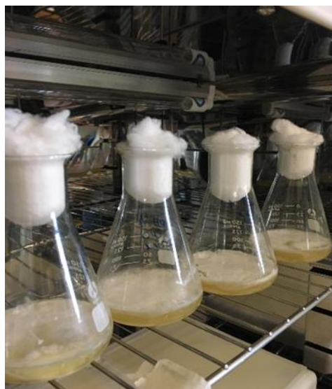
Εικόνα 4.4.-1 Εμβολιασμός της ζύμωσης με προκαλλιέργεια του μύκητα Trametes sp. (αριστερά) και κωνικές φιάλες κατά τη διάρκεια της ζύμωσης (δεξιά).
