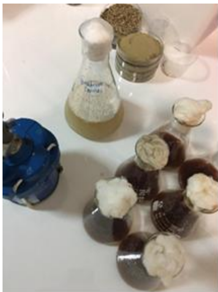
Εικόνα 4.4.-1 Εμβολιασμός της ζύμωσης με προκαλλιέργεια του μύκητα Trametes sp. (αριστερά) και κωνικές φιάλες κατά τη διάρκεια της ζύμωσης (δεξιά).
