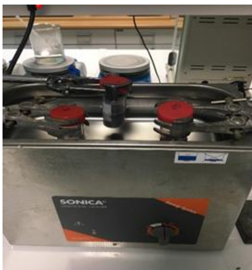
Εικόνα 4.3.1-1 Διαδικασία εκχύλισης φαινολικών συστατικών από στέμφυλα με χρήση συσκευής υπερήχων (αριστερά) και εξάτμιση του διαλύτη με περιστροφικό εξάτμιστήρα (δεξιά).
