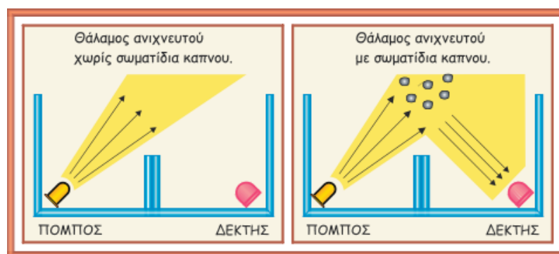
Εικόνα 3. Ανιχνευτής ορατού καπνού, Olympia electronics
