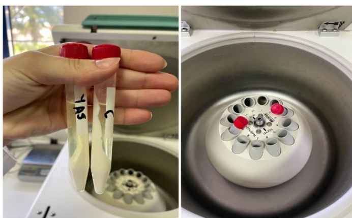
Εικόνα 4. Φυγοκέντρηση δειγμάτων γιαουρτιού για τη μέτρηση της ικανότητας συγκράτησης νερού (Πηγή: Προσωπικό αρχείο).
