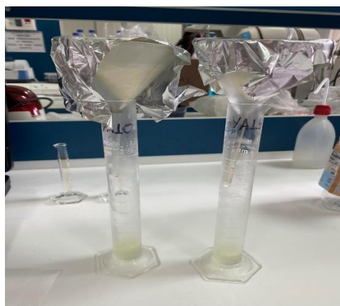
Εικόνα 5. Μέτρηση συναίρεσης των δειγμάτων γιαουρτιού ύστερα από 5 h (Πηγή: Προσωπικό αρχείο).
