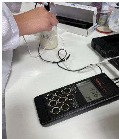
Εικόνα 2. Μέτρηση pH του γιαουρτιού με pH-μετρο (Πηγή: Προσωπικό αρχείο).
