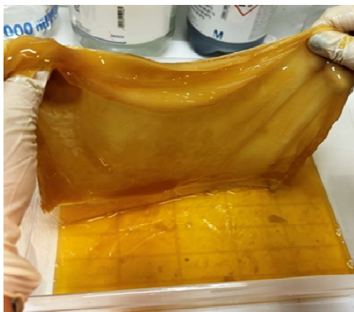
Εικόνα 3.5: Βακτηριακή νανοκυτταρίνη πριν και μετά την έκπλυση
