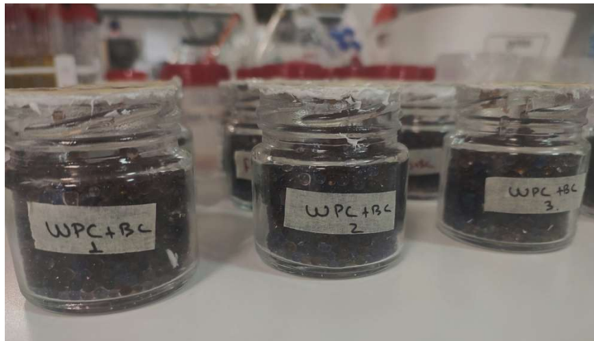
Εικόνα 3.8: Προετοιμασία δειγμάτων για τον προσδιορισμό της διαπερατότητας υδρατμών
