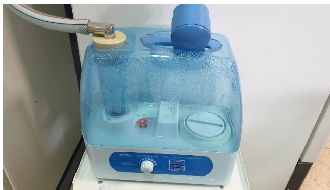
Εικόνα 6. Ειδικός θάλαμος ελεγχόμενης υγρασίας όπου τοποθετούνται οι μεμβράνες
